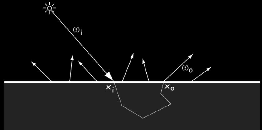
$$\text{BSSRDF} \quad S(x_i, \vec{\omega}_i, x_o, \vec{\omega}_o) = \frac{dL(x_o, \vec{\omega}_o)}{d\Phi(x_i, \vec{\omega}_i)}$$
