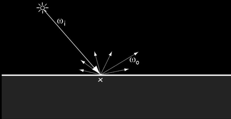
$$\text{BRDF} \quad f_r(x, \vec{\omega}_i, \vec{\omega}_o) = \frac{dL(x, \vec{\omega}_o)}{dE(x, \vec{\omega}_i)}$$
